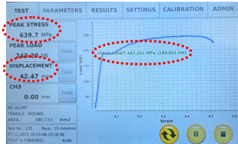
Gambar 3. Hasil uji tarik menggunakan mesin uji tarik terhadap baja tulangan beton sirip/ulir S 22
