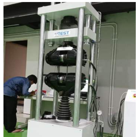
Mesin uji tarik kapasitas 60 ton
