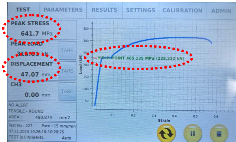
Gambar 4. Hasil uji tarik menggunakan mesin uji tarik terhadap baja tulangan beton sirip/ulir S 25
