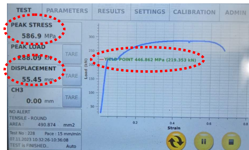
Gambar 5. Hasil uji tarik menggunakan mesin uji tarik terhadap baja tulangan beton sirip/ulir S 19
