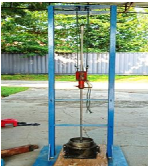
(a) Alat Penumbuk memadatkan sampel
