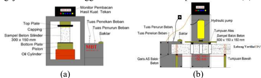
Gambar 7. Tampak ilustrasi proses pengujian (a) kuat tekan dan (b) kuat lentur
