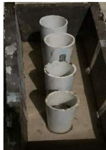
Gambar 4. Penempatan Pipa pada Cetakan Balok
