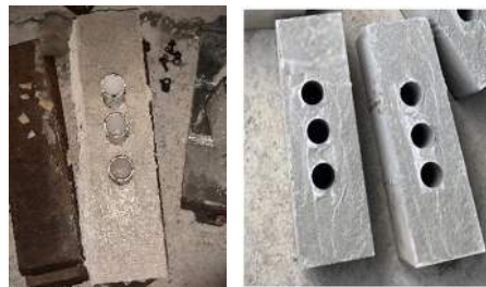
Gambar 6. Proses Pelepasan Cetakan dan Pipa
