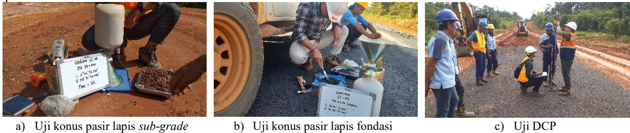
Gambar 17 Pelaksanaan uji parameter mekanik di lapangan
