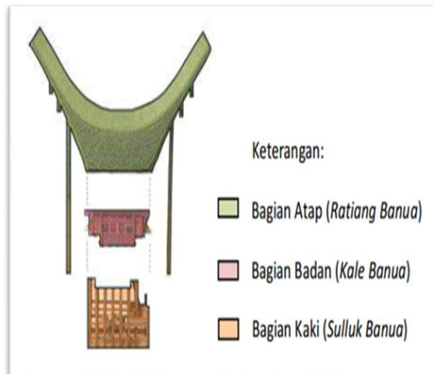
Gambar 1 Pembagian Struktur Rumah Tongkonan
