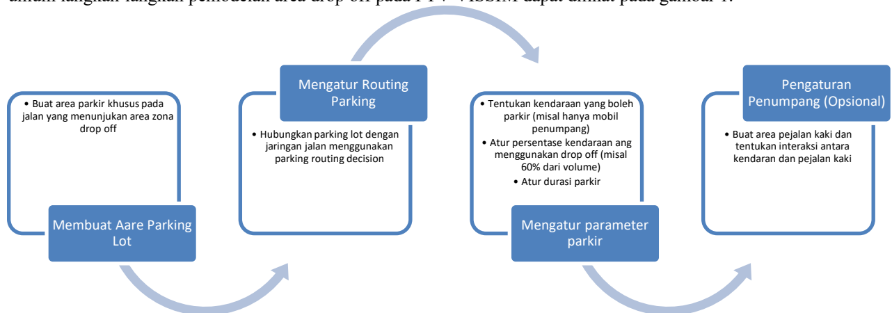
Gambar 1. Metode Pemodelan Area Drop Off pada PTV VISSIM
