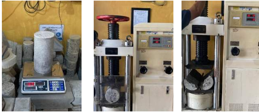
Gambar 3. Sampel Benda Uji Umur 7 Hari dan Pengujian Kuat Belah
