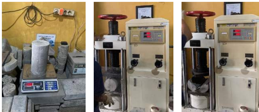
Gambar 4. Sampel Benda Uji Umur 7 Hari dan Pengujian Kuat Belah
